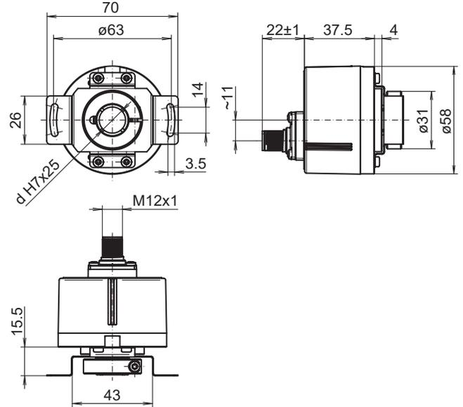
Bague de serrage coté bride: Axe creux non traversant, embase M12 axial
