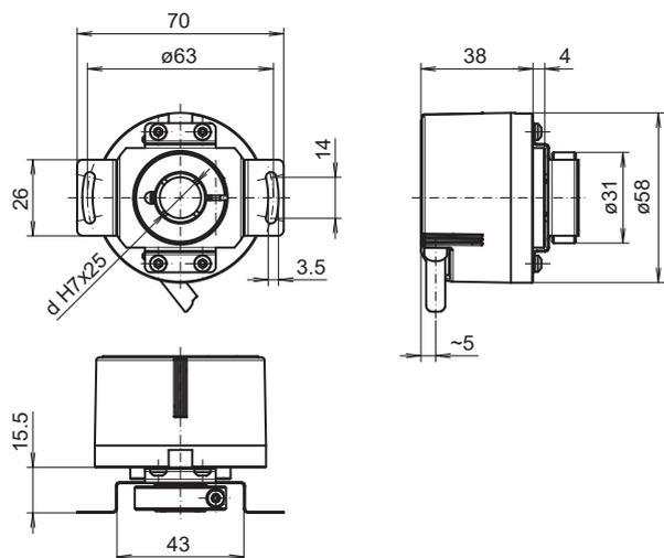
Bague de serrage coté bride: Axe creux non traversant, câble tangen-
