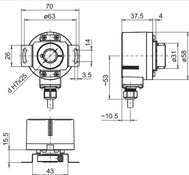
Bague de serrage coté bride: Axe creux non traversant, câble radial
