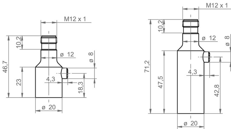
Kurzes Gehäuse mit Steckverbindung M12-A
