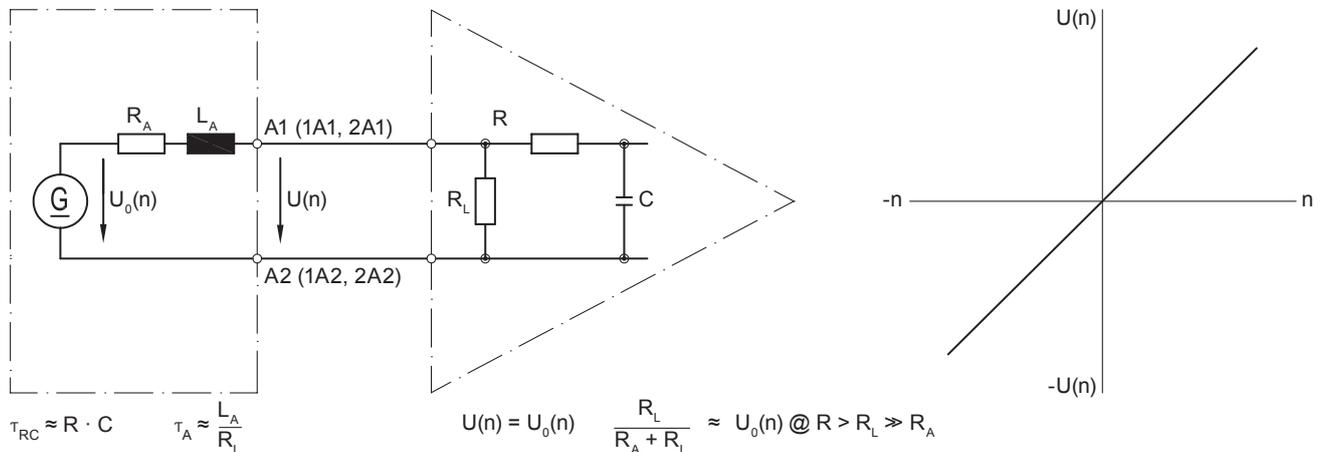
Polarité pour sens de rotation positif (voir dimension) / A1 (1A1, 2A1): + (VDE) / A2 (1A2, 2A2): - (VDE)
