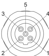
Abb. 8: Buchse (5-polig, B-codiert)
