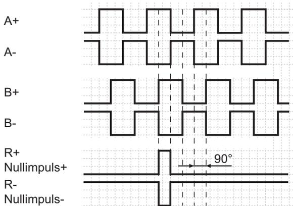
Abb. 10: Ausgangssignale bei positiver Drehrichtung
