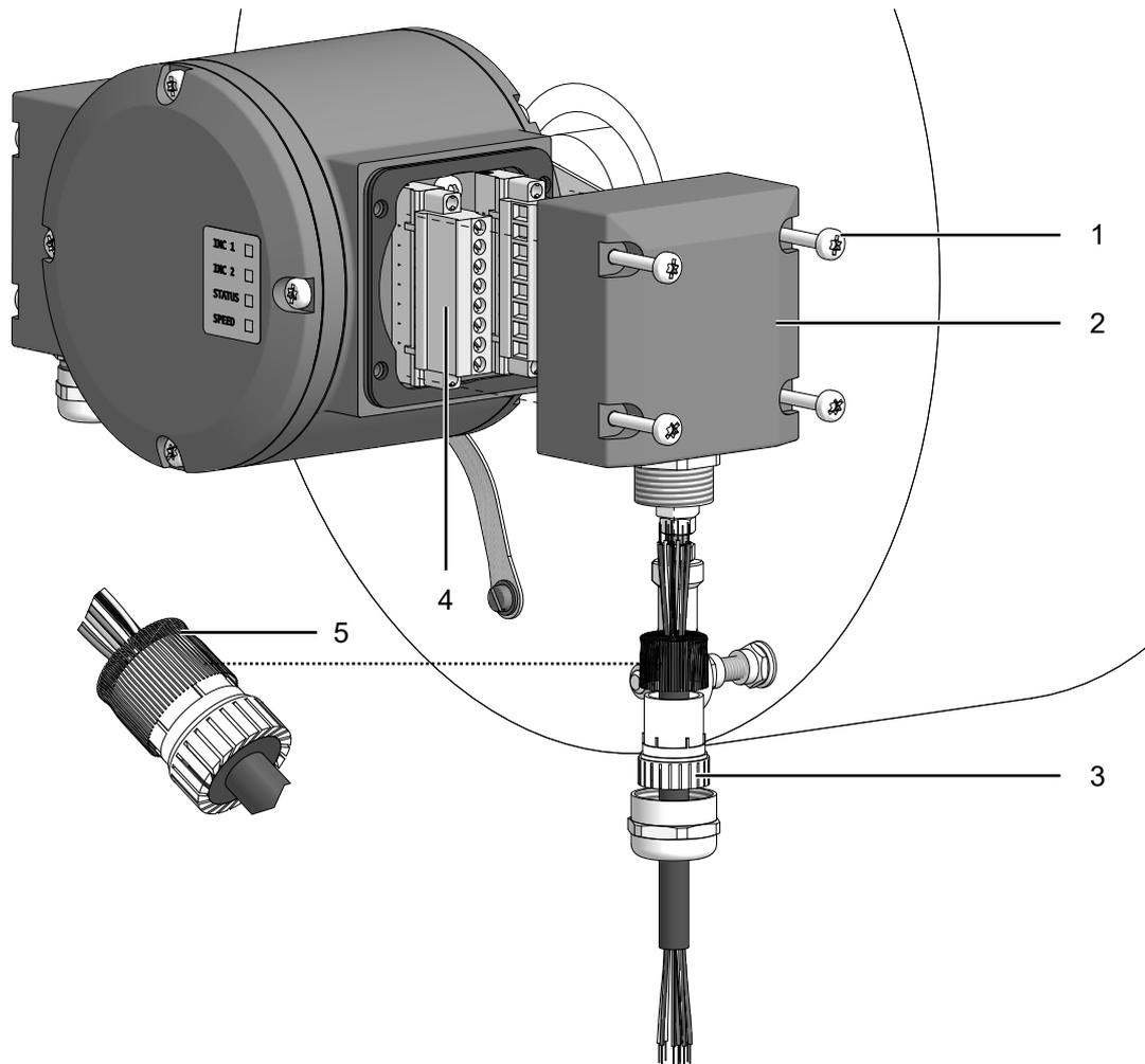
Abb. 11: Anschlusskabel anschliessen
