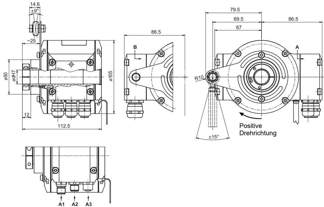
Abb. 17: Abmessungen der durchgehenden Hohlwelle (Abmessungen in mm, wenn nicht anders angegeben)
