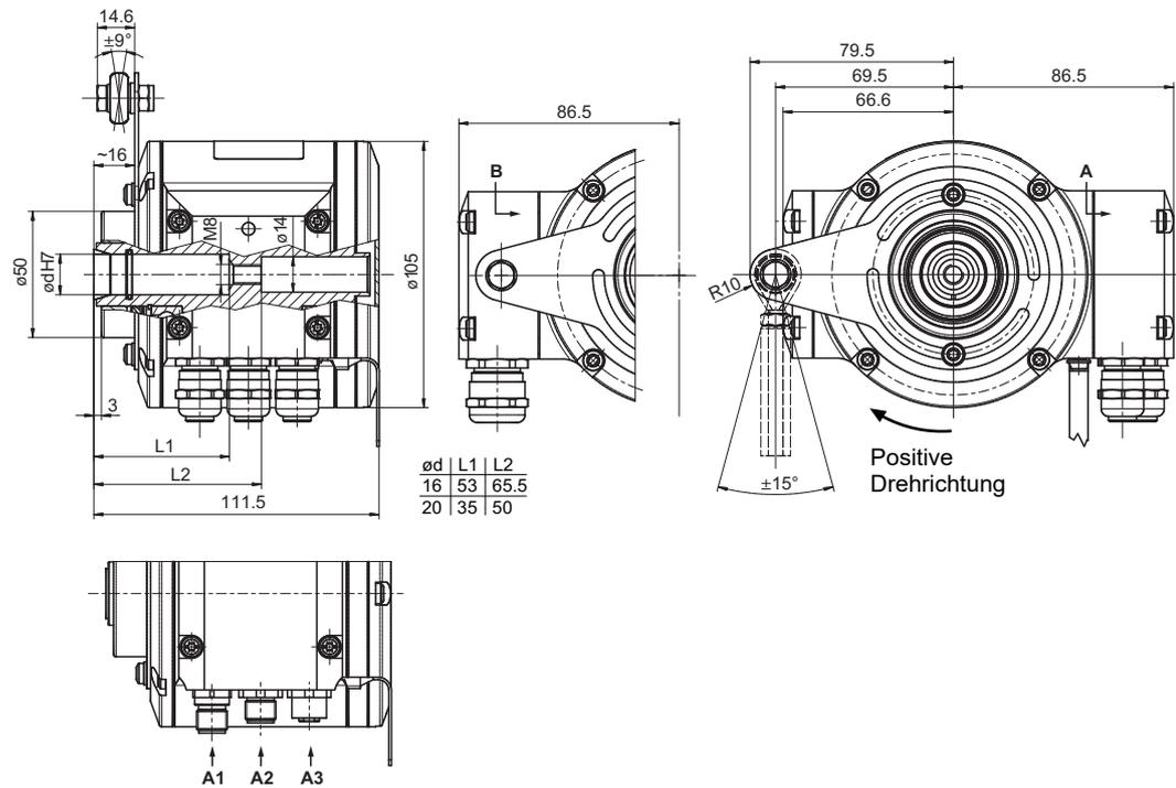
Abb. 15: Abmessungen der einseitig offenen Hohlwelle (Abmessungen in mm, wenn nicht anders angegeben)
