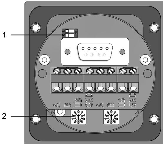
Abb. 9: Anschlusskasten HMG10 Profibus DP
