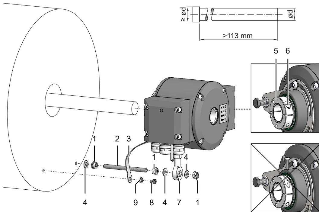
Abb. 14: Sensor mit durchgehender Hohlwelle demontieren
