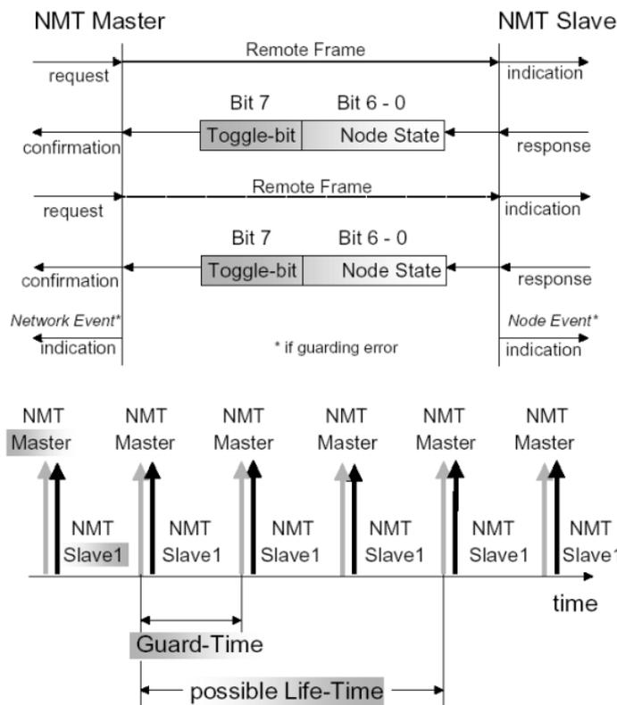
Zur Überwachung der Teilnehmer kann das Nodeguarding-Protokoll verwendet werden. Die CANopen-Nutzerorganisation *Can in Automation CiA* hat die Weisung herausgegeben, dass man wenn möglich das aktuelle Überwachungsprotokoll Heartbeat verwenden sollte. Will man trotzdem das Nodeguarding verwenden, muss im Objekt 2110h das Bit5 gesetzt werden.
