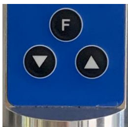
Abb. 6: Beispiele von robusten Bedienelementen ohne Gehäuseöffnungen
