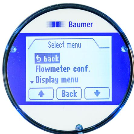
Das Menü des Displays ermöglicht den Zugriff auf wichtige Systemparameter und Einstellungen des Durchflusssensors.
