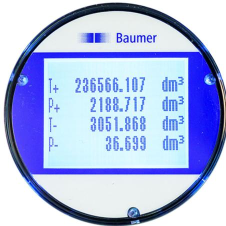
Wichtige Systemparameter und die Menüfunktionen können im Display des Durchflusssensors angezeigt und konfiguriert werden.
