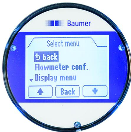
Le menu de l'écran d'affichage permet l'accès à certains paramètres et réglages importants du système du débitmètre.
