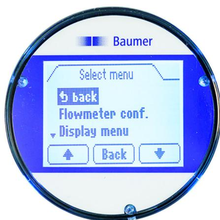
Il menù del display consente di accedere a importanti parametri di sistema e alle impostazioni del sensore di flusso.
