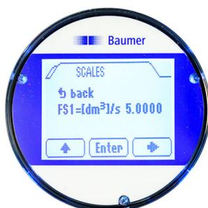
**11.** ▶ Selezionare l'unità per il valore di fondo scala con il tasto freccia [Destra].
