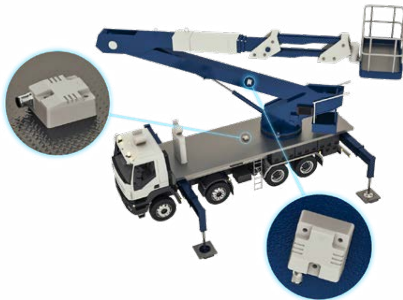
GIM500R: Poziomowanie pojazdu i pozycjonowanie wysięgnika.
