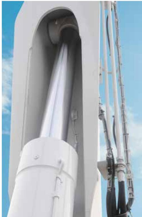
Ein unten am Hauptmast aufgeschraubter Dehnungssensor nimmt die Bewegung vom Verteilermast auf und liefert das Signal für die Schwingungsdämpfung an die Steuerung.
