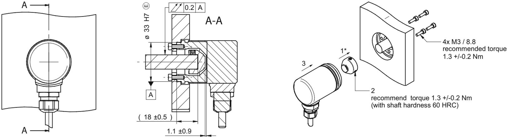
Magnettläufer und Drehgeber nicht separieren. Andernfalls kann die Genauigkeit nicht garantiert werden, da Magnet und Sensor abgeglichen sind.
