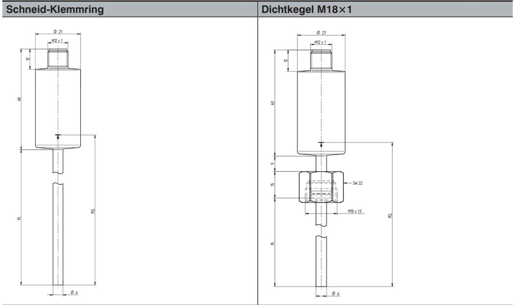
Prozessanschlusslänge PCL bei Schneid-Klemmring = Stablänge PL + 9 mm
