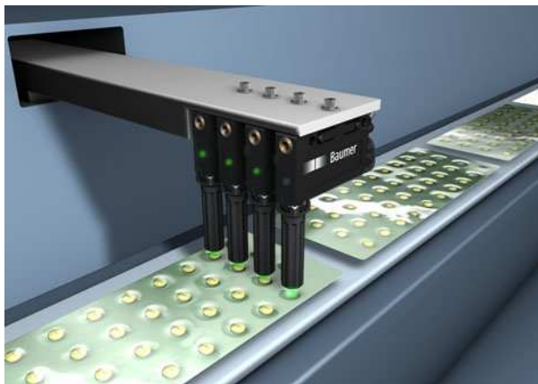
Bild 5: Ultraschall-Sensoren kontrollieren die Anwesenheit von Tabletten in Blisterverpackungen
