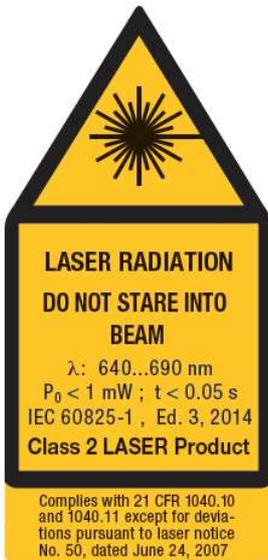
Der im **Scatec-10 / -15** eingebaute Diodenlaser sendet sichtbares rotes Licht aus. Gemäss der Norm IEC 60825-1 / 2014 gehört dieser Laser zur Laserklasse 2.
