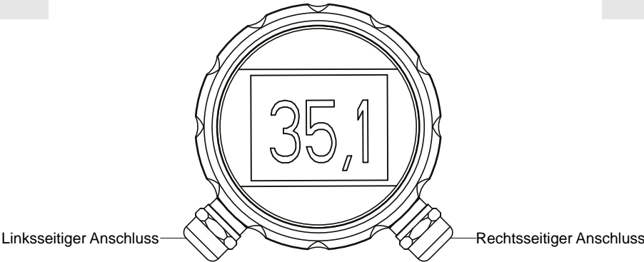
Linksseitiger Anschluss (Vorderansicht): M12-A, 5-Pin
