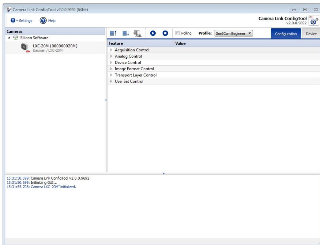
自定义协议兼容 GenICam™ 的核心组件 CLProtocol DLL (动态链接库)。它集成在图像采集卡的 SDK 中，支持通过软件环境进行相机参数设置和图像采集。但是，这种方法需要集成和支持多个厂商不同操作系统的软件组件，成本非常高。为了避免这一问题和额外的工作量，GenCP (通用控制协议) 协议被标准化为新的配置协议。堡盟新型 LX 系列 Camera Link® 相机集成 GenCP 协议，大大提高用户的安装便利性。在相机集成过程中，只需指定图像采集卡是否支持 GenCP。如果选择不支持，可使用便捷的配置工具对整个相机进行配置。然后需要集成至客户的应用中，这有赖于 GenICam™ 标准实施方案，可通过专门开发的 SDK 衍生工具和相应的配置示例实现。该协议的应用日益广泛，使更多的图像采集卡支持 GenCP。借此，可以直接通过图像采集卡的 SDK 轻松实现相机配置，而无需借助任何其他相机制造商的软件。为了进一步简化
