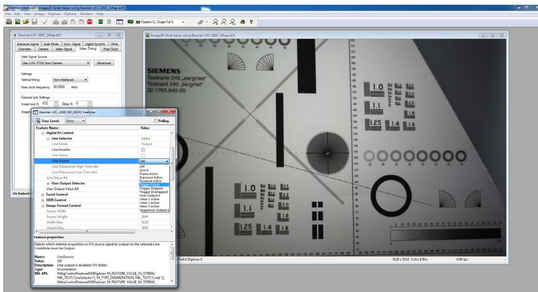
通过支持 GenCP 的图像采集卡，可直接在厂商的 SDK 中进行相机配置。随着 GenCP 越来越成熟，这种方法将进一步被市场认可。
