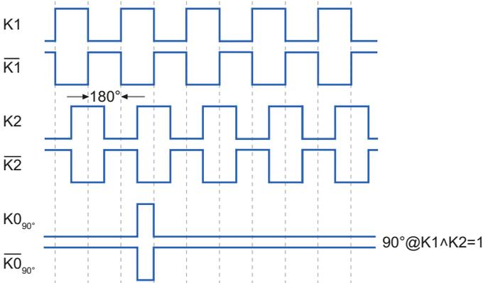
Bei positiver Drehrichtung / im Uhrzeigersinn, mit Blick auf die Drehgeberwelle
