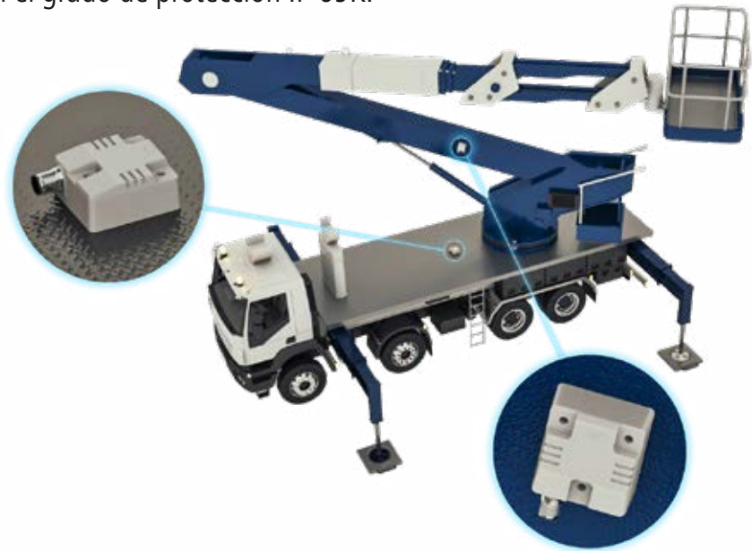
GIM500R: Nivelación del vehículo y posicionamiento del pescante
