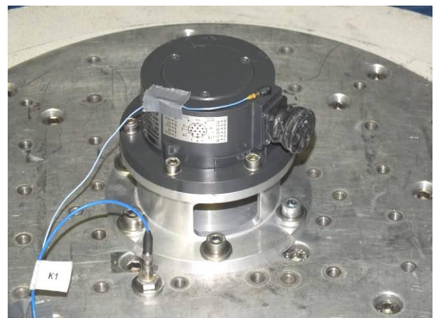
Bild 6 Drehgeber FOG 9 auf dem Schwingtisch mit Beschleunigungssensoren beim Schwingen und Schocken in der Z-Achse
