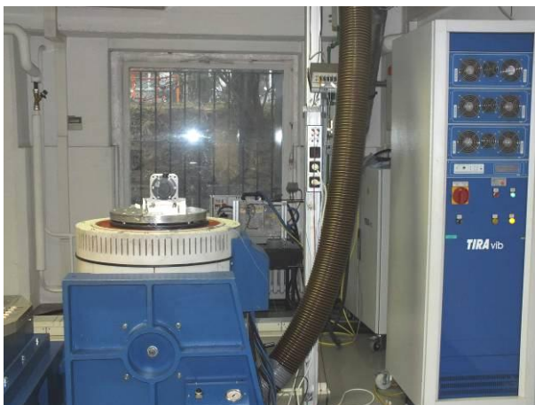
Bild 3 Drehgeber FOG 9 auf der Schwingprüfanlage beim Schwingen und Schocken in der Y-Achse
