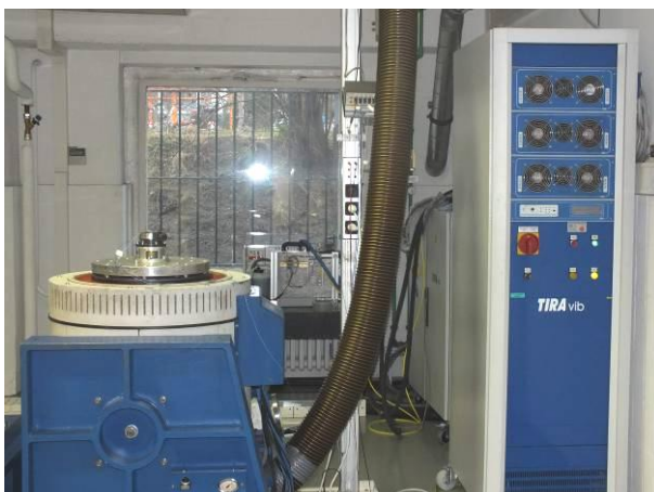
Bild 5 Drehgeber FOG 9 auf der Schwingprüfanlage beim Schwingen und Schocken in der Z-Achse
