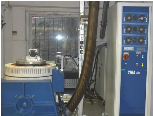
Bild 1 Drehgeber FOG 9 auf der Schwingprüfanlage beim Schwingen und Schocken in der X-Achse
