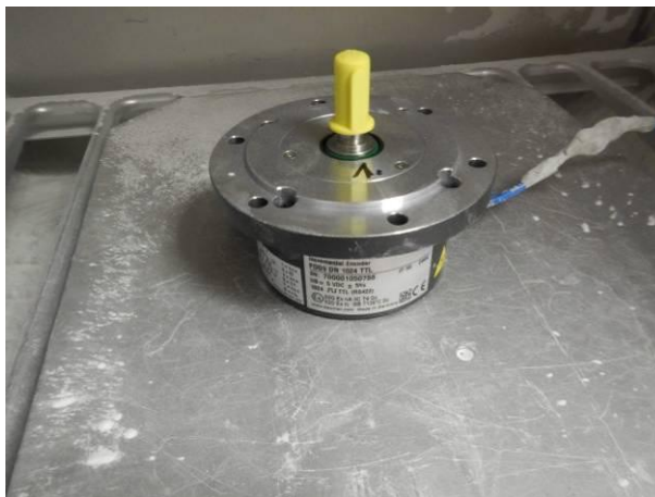
Bild 3 Drehgeber FOG9 DN 1024 TTL in der Staubkammer SK 160 vor der Staubschutzprüfung IP6X
