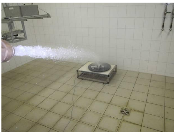
Bild 5 Drehgeber FOG9 DN 1024 TTL auf dem Drehteller mit genormtem Wasserstrahl während der Strahlwasserschutzprüfung IPX6
