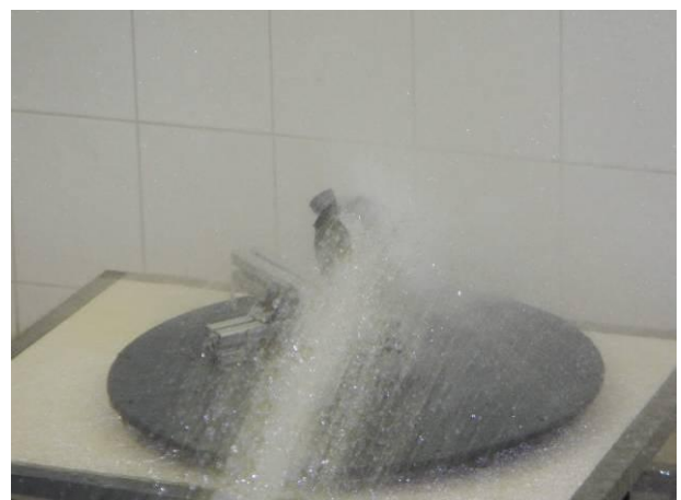
Bild 6 Drehgeber FOG9 DN 1024 TTL auf dem Drehteller mit genormtem Wasserstrahl während der Strahlwasserschutzprüfung IPX6
