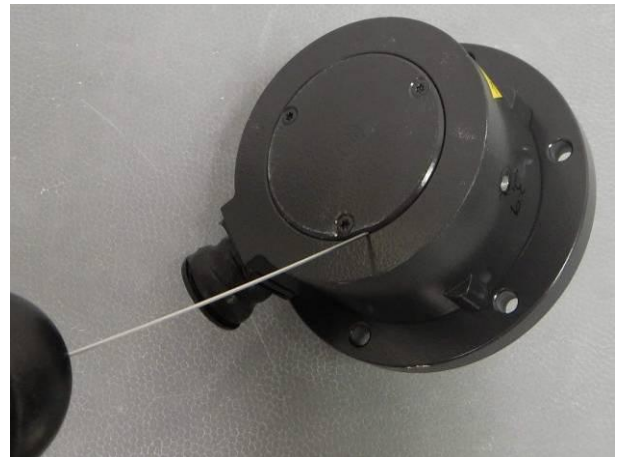
Bild 2 Drehgeber FOG9 DN 1024 TTL mit genormten Prüfdraht (Ø 1 mm, 1 N) während der Berührungsschutzprüfung IP6X
