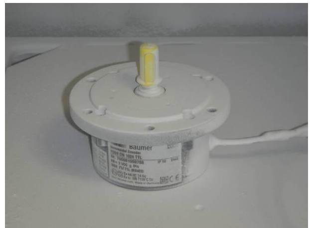
Bild 4 Drehgeber FOG9 DN 1024 TTL und Nr. 5.2 - in der Staubkammer SK 160 nach der Staubschutzprüfung IP6X
