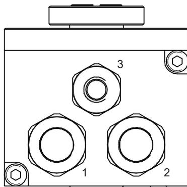
Kabel: 1, 2 =  $\varnothing$ 8-10 mm (-40-85 °C) /  $\varnothing$ 5-9 mm (-25-85 °C)
