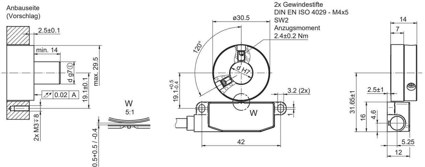
EB200E.IR-FN mit EBS.R-FN032.S für Schraubmontage
