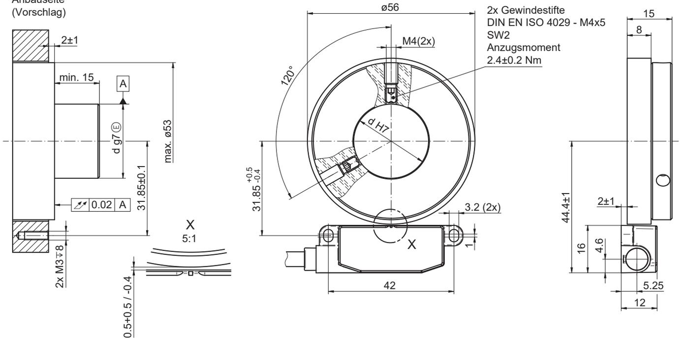
EB200E.IR-FN mit EBS.R-FN064.S für Schraubmontage
