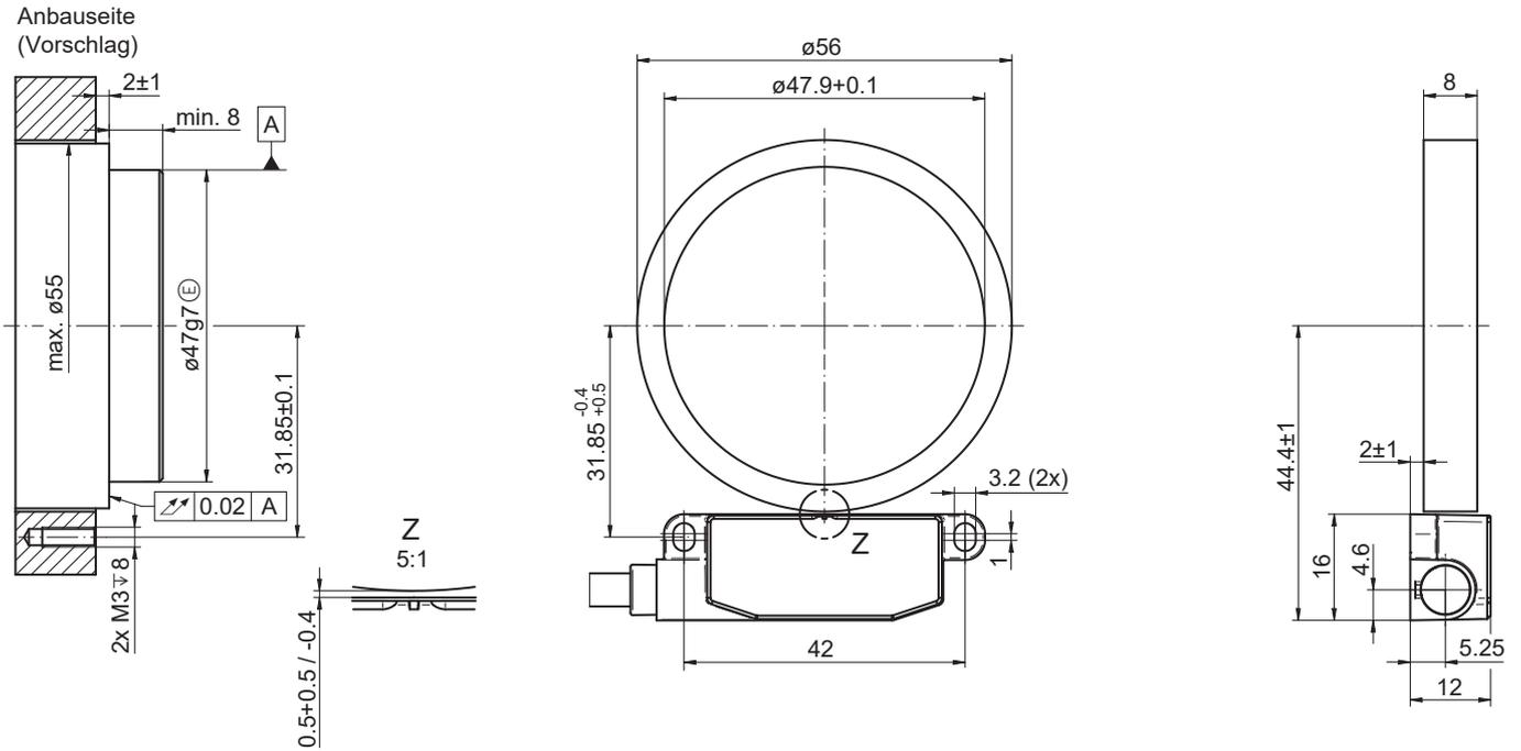
EB200E.IR-FN mit EBS.R-FN032.B zum Kleben
