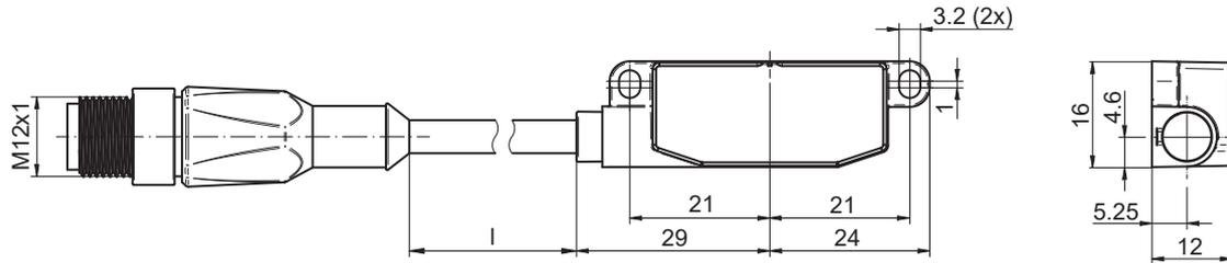
EB200E.IR-FN mit Kabel und Stecker M12
