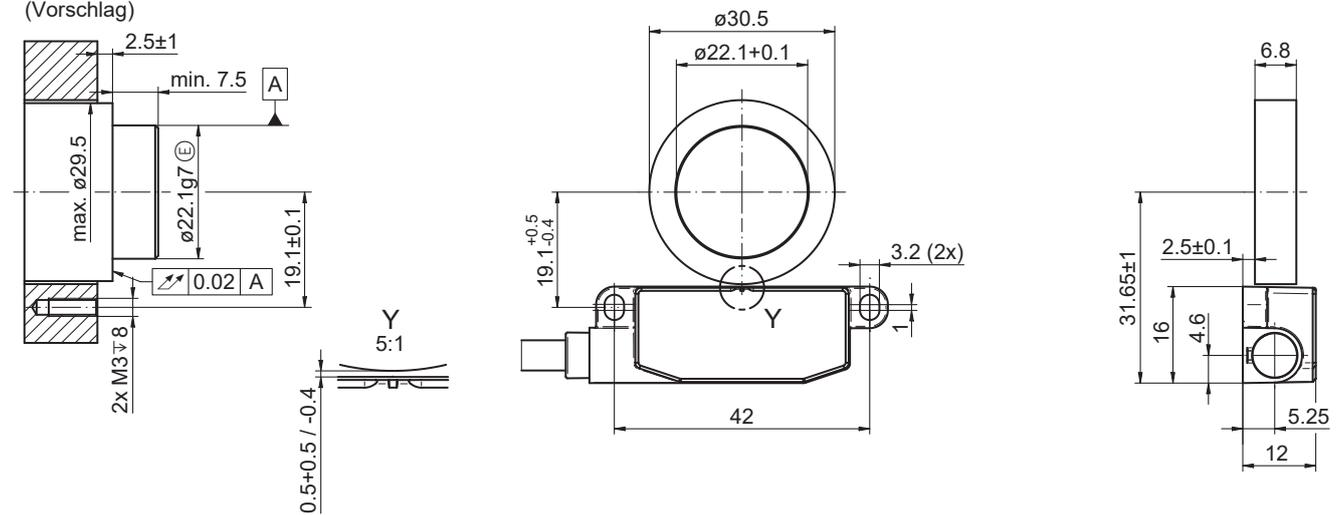
EB200E.IR-FN mit EBS.R-FN032.B zum Kleben
